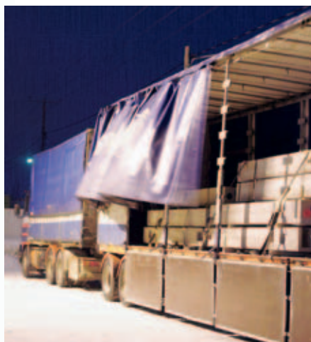
Elpo-elementit toimitetaan kerroksittain niputettuina suoraan tehtaalta tilaajan rakennustyömaalle.
