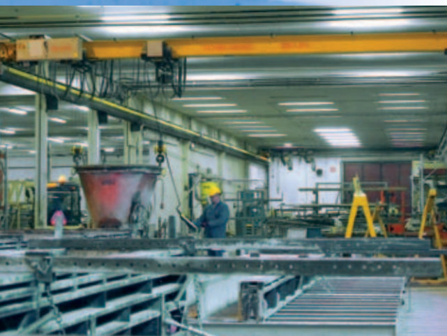
Betonirunkoiset elpo-elementit valetaan nousuittain. Tällä varmistetaan, että putket, muhvit ja yhteydet sopivat asennuksessa varmasti toisiinsa.
