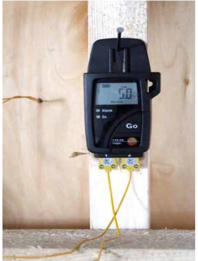
Kuva 19 Lämpötilan mittauslaite (loggeri) edestä
