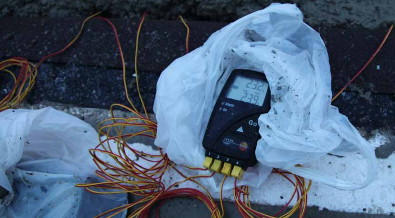
Kuva 3 Lämpötilan seurantalaitte, 4-kanavainen datalogger
