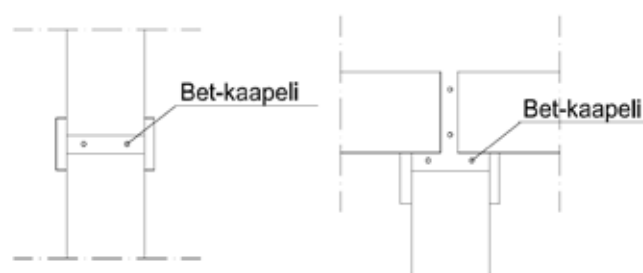
Kuva 12 Betonilämmityskaapelin sijoitus päittäis- ja T-saumoissa
