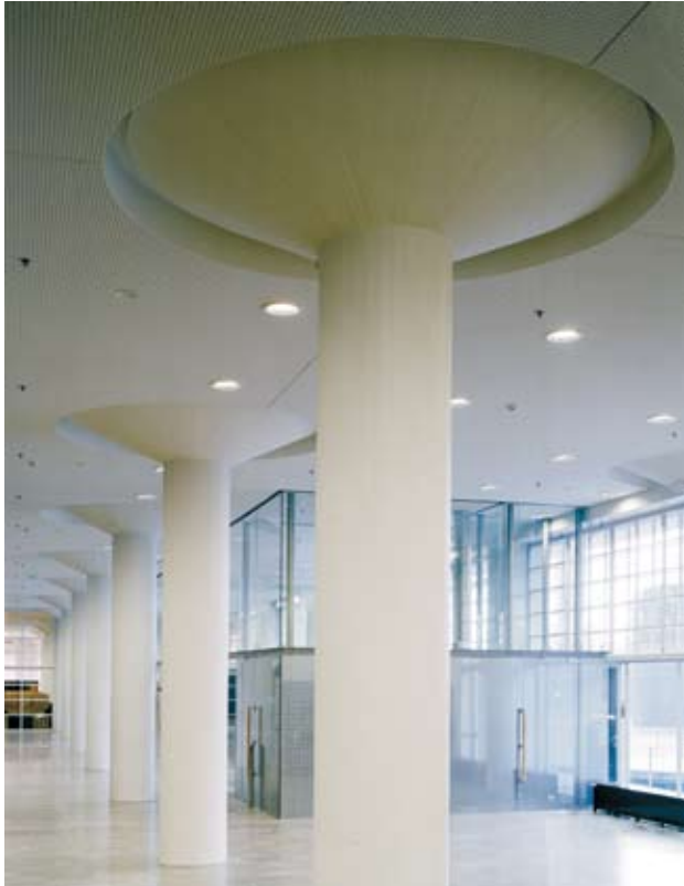
Itsetiivistyvällä betonilla valettua pintaa.
