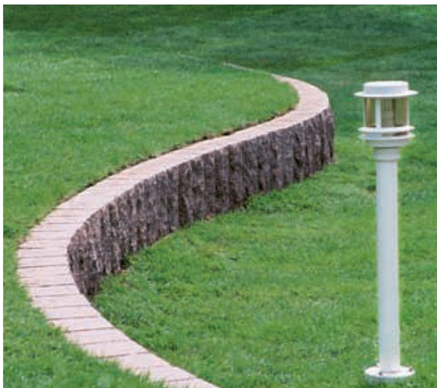
Aitakivimuurin voi asentaa kaarevaksi. Vakiotuotteella kaarevuuden minimisäde on noin 3,5 m.
